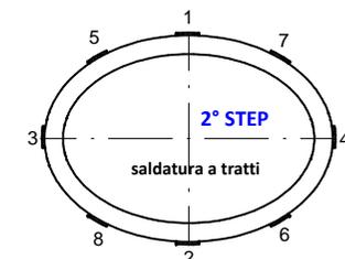
5. Per evitare il surriscaldamento e la conseguente deformazione del telaio, si consiglia di saldare con il metodo TIG ( UNI ISO 287-1)
